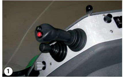
Sněhová V-radlice je zdvižena řídicí pákou
