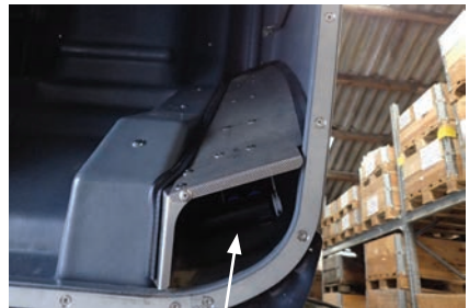
Odstraňte poklop na každém filtru
