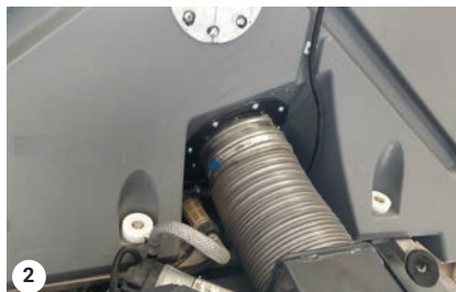
Odpojte vnější hadici uvolněním hadicové spony
