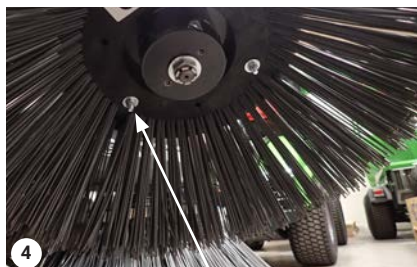
Povolte 3 matice a vyměňte kartáč
