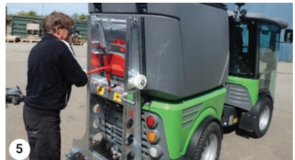
Zatlačte rám přídatného zařízení a zajistěte, aby háky byly umístěny ve zdvihacích zařízeních.
