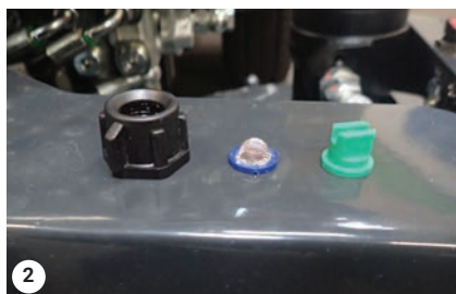
Vyjměte filtr a tryšku a vyčistěte
