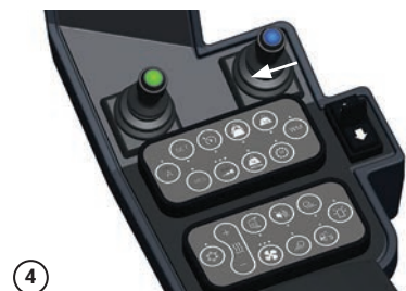
Nakloňte a otočte pravý kartáč dovnitř
