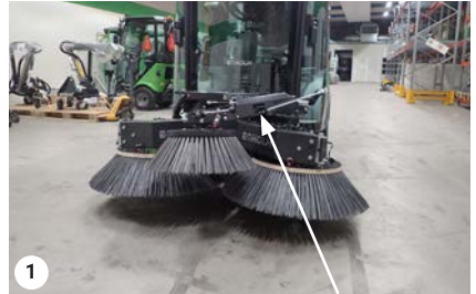
1 Nastavení zvedacího bodu (matice M10)
