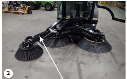
2 Odstraňte kryt (kartáč ve vnější poloze)
