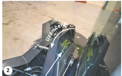
Otočte pojistnou páčku do zajištěné polohy.
