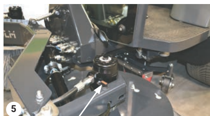
5 Ventil umístěný na předním kartáči pro 3. a 4. trysku
