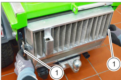
Obr. 182 Odstranění krytu chladiče vody
