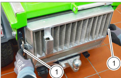
Obr. 174 Odstranění krytu chladiče vody
