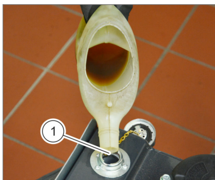
Obr. 235 Plnění hydraulického oleje
