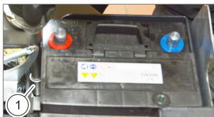
Obr. 257 Uvolnění montážního šroubu baterie
