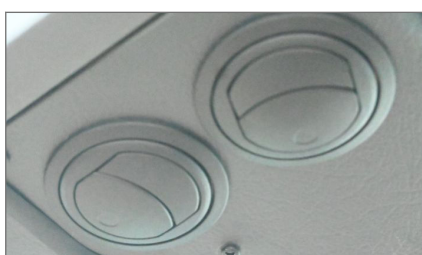
Obr. 154 Vzduchové ventilační otvory
