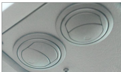
Obr. 57 Otvory pro vytápění/ventilaci vzduchem
