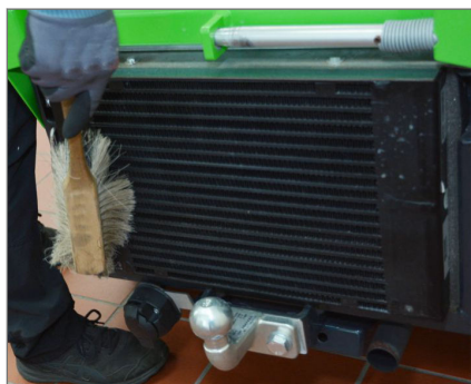
Obr. 183 Vymetání chladicích žeber
